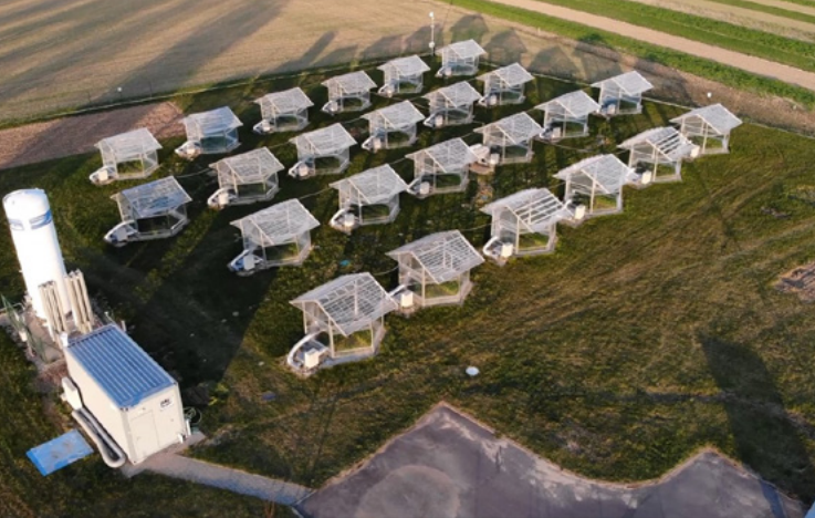
Výzkumná infrastruktura Domanínek z Bystřice nad Pernštejnem pro stanovení dopadů změny klimatu na růst a vývoj polních plodin. Manipulační experiment zahrnuje 24 kulturních komor s umělou atmosférou se zvýšenou koncentrací CO 2 , řízenou teplotou či zatahovacími střechami pro simulaci sucha. Zdroj: www.czechglobe.cz
