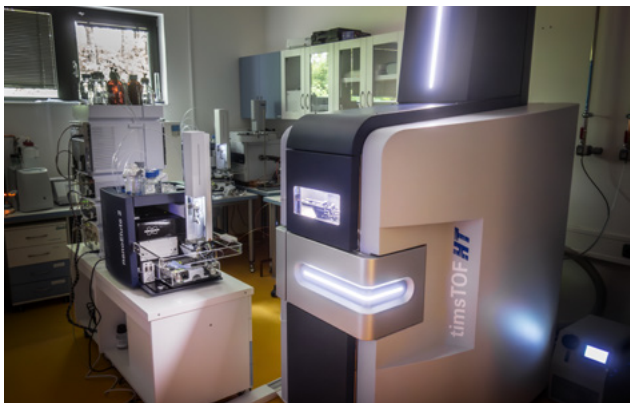
Hmotnostní spektrometr s vysokým rozlišením slouží k detailní analýze extraktů mikroorganismů. Umožňuje ověřit, zda kmeny vybrané procesem fenotypizace produkují požadované bioaktivní látky využitelné v biotechnologiích
