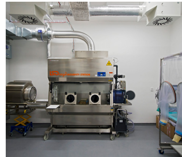
Speciální zařízení, které umožňuje chov myši bez přítomnosti mikrobů
