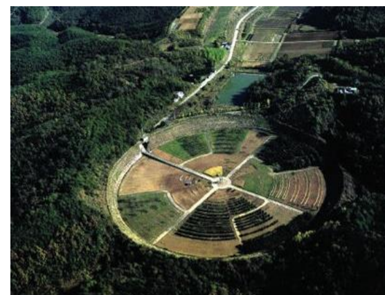
Japonský ústav radiačního šlechtění (gama pole, poloměr 100m, zářič 88.8 TBq ^{60}\text{Co} )
