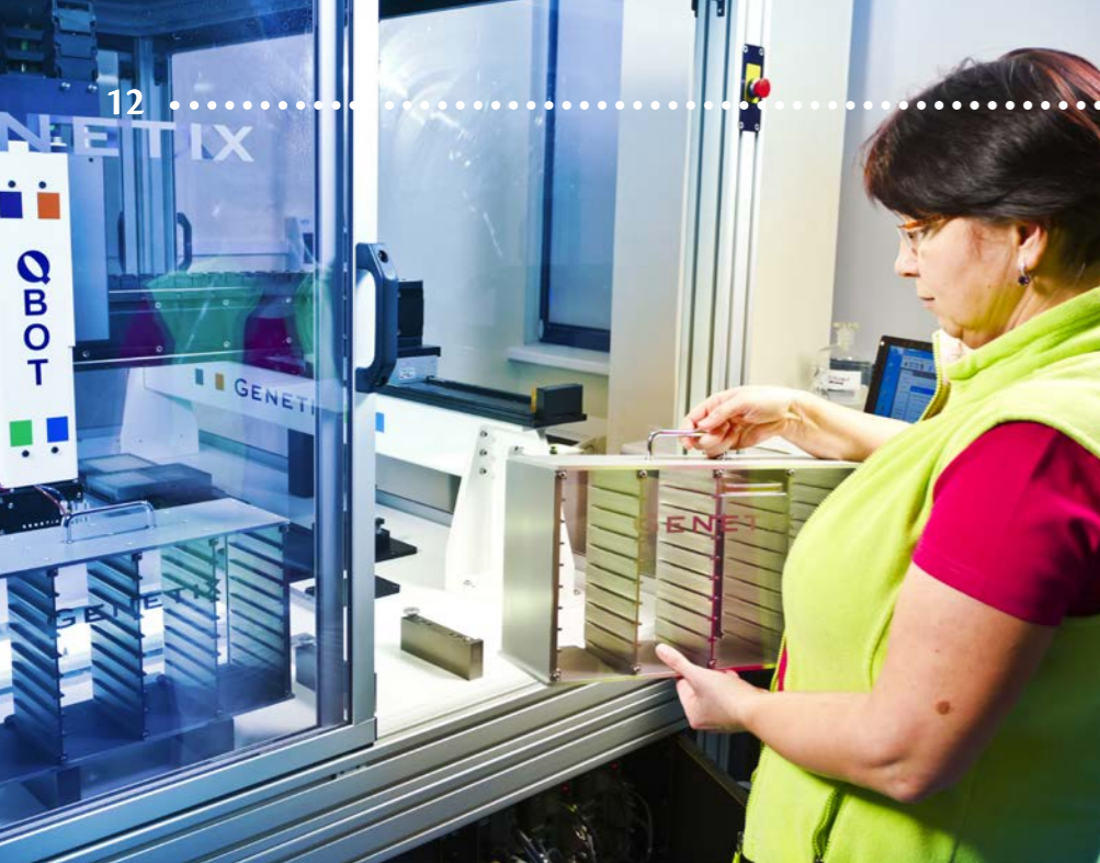
Automatizovaný robotický systém Q-BOT (Genetix, UK) je vícefunkční přístroj používaný při přípravě a manipulacích s knihovnami DNA.
